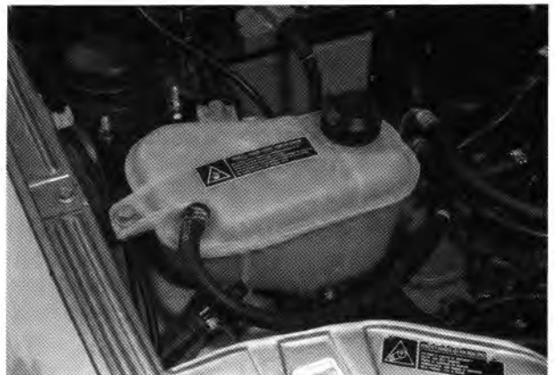
Rys. 1.56. Usytuowanie zbiornika wyrównawczego poziomu cieczy chłodzącej
