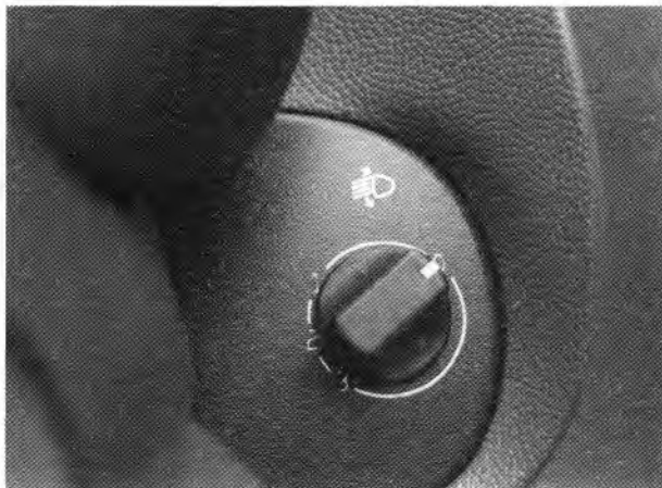
Rys. 1.28. Usytuowanie pokrętki elektrycznego korektora ustawienia reflektorów (opis w tekście)
