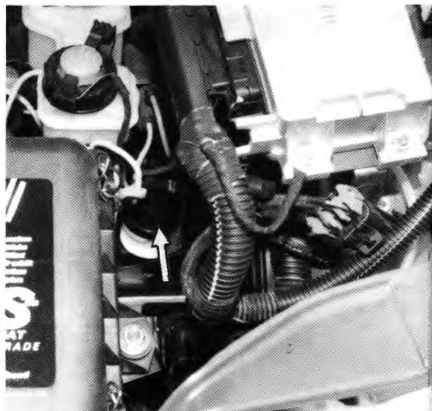
Rys. 1.57. Usytuowanie zbiorniczka płynu hydraulicznego układu sterowania sprzęgłem (strzałka wskazuje zbiorniczek)
