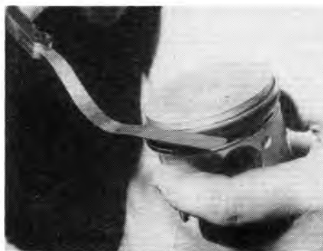
Rys. 2.170. Sprawdzanie luzu pierścienia tłokowego w rowku (silniki 899 i 1108)
