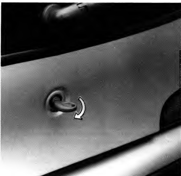
Rys. 1.45. Otwieranie pokrywy przedziału bagażnika kluczykiem wyłącznika zapłonu (strzałka wskazuje kierunek przekręcenia kluczyka)
