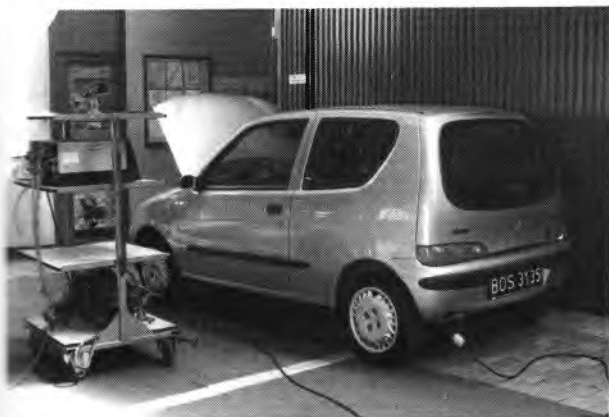
Rys. 2.103. Widok analizatora spalin podłączonego do końcówki rury wylotowej
