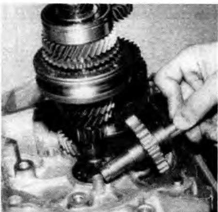
Rys. 4.17. Wymontowanie wałka z kołem zębatym biegu wstecznego
