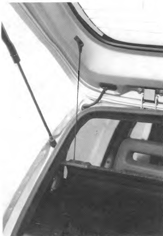
Rys. 1.48. Zamocowanie półki tylnej na linkach
