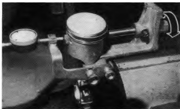
Rys. 2.174. Sprawdzanie siły osiowej niezbędnej do przesunięcia sworznia tłoka w korbowodzie
