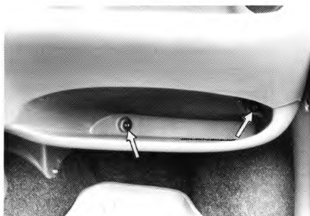
Rys. 11.41. Śruby mocujące tablicę rozdzielczą, znajdujące się w schowku po prawej stronie tablicy rozdzielczej
