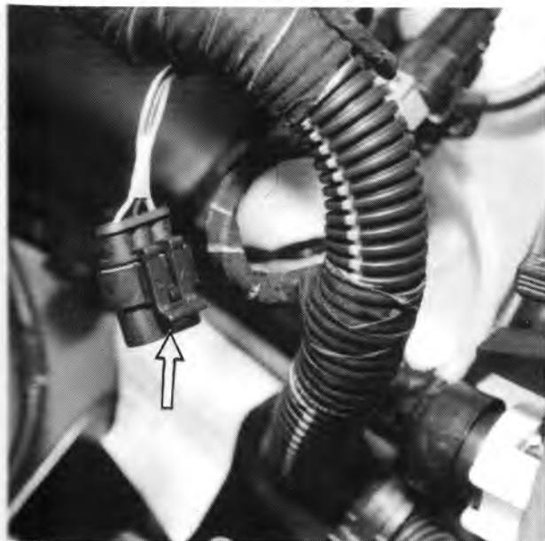
Rys. 2.39. Umiejscowienie złącza diagnostycznego (strzałka wskazuje złącze diagnostyczne)
