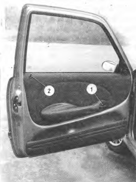
Rys. 1.16. Klamka wewnętrzna i blokada drzwi 1 – klamka wewnętrzna, 2 – przycisk blokady
