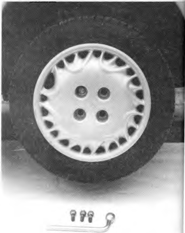
Rys. 1.64. Kołpak koła założony na pierwszą śrubę mocującą koło
