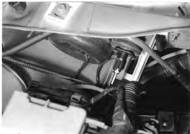
Rys. 1.26. Usytuowanie korektora ustawienia reflektorów (strzałka wskazuje korektor)
