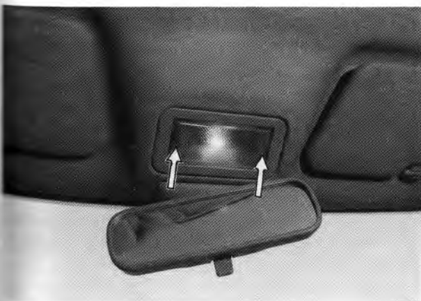
Rys. 1.31. Usytuowanie lampki oświetlenia wnętrza nadwozia (strzałki wskazują miejsca naciśnięcia klosza lampki)
