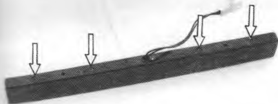
Rys. 1.81. Oprawka żarówek zamontowana w kloszu lampy przed wymontowaniem (wskazówki wskazują wkręty mocujące)
