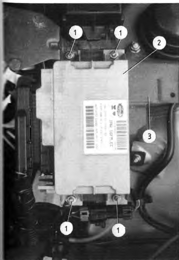
Rys. 2.6. Zamocowanie elektronicznego urządzenia sterującego w samochodzie z silnikiem 899
