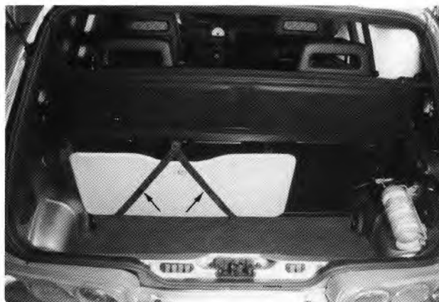
Rys. 1.34. Sposób umocowania wymontowanej osłony przeciwsłonecznej (strzałki wskazują paski mocujące)
