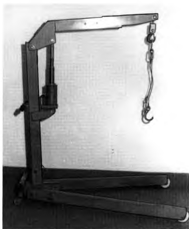
Rys. 2.142. Podnośnik hydrauliczny do unoszenia i przewożenia zespołu napędowego
